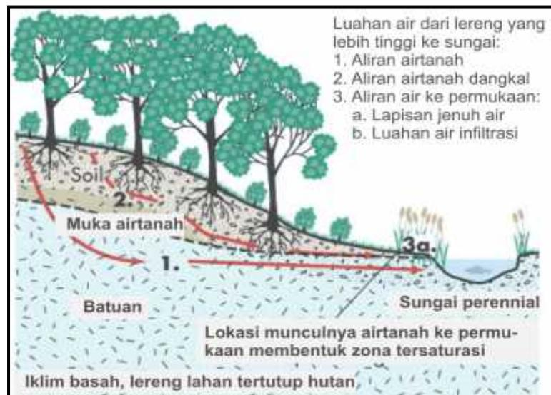
Gambar 5.6 Imbuhan dan luahan pada daerah beriklim basah (Keller, 2000). Lahan bergradien lereng tinggi yang tertutup vegetasi memungkinkan untuk terjadi resapan air ke dalam tanah, yang selanjutnya muncul mengisi sungai perennial (efluen).
