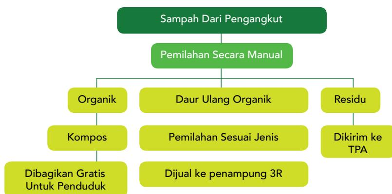
Gambar 2.5: Diagram yang memperlihatkan bagaimana TPS-3R beroperasi saat ini
