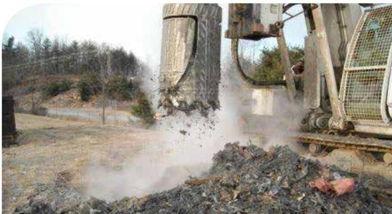
Gambar 4.4: Bucket auger dalam pengoperasian.
