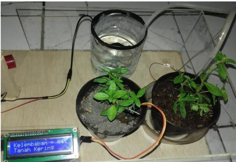
Gambar 42. Ketika kondisi tanah kering dan pompa menyiram
