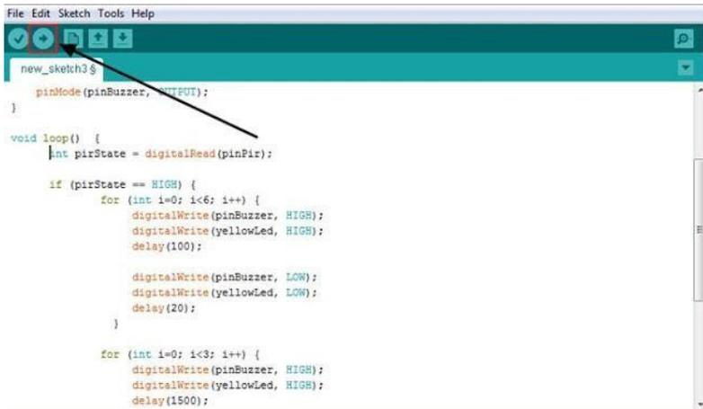
Gambar 12. Tombol untuk upload data ke arduino
