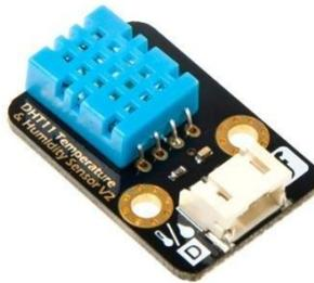
Gambar 33. Sensor Kelembaban Udara dan Temperatur Dht11
