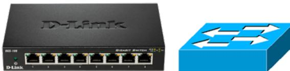
**Gambar 8.9:** Perangkat Switch dan Simbol Switch
